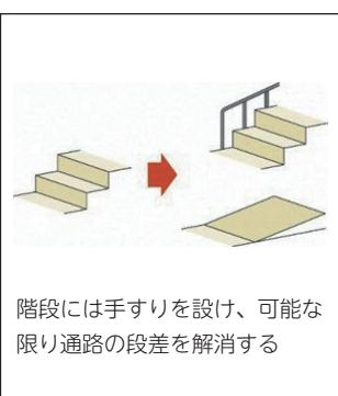
階段には手すりを設け、可能な限り通路の段差を解消する
