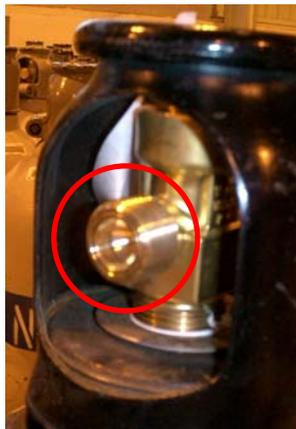
接続部分のネジに損傷等異常がないこと、また容器によって右ネジ、左ネジのものがあることを確認する。
