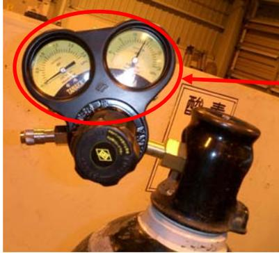
調整器一次側圧力計に十分圧力があることを確認する。
